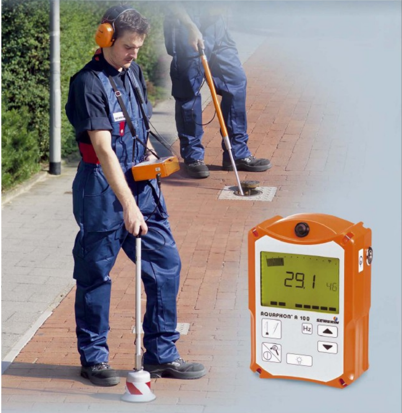
AQUAPHON A100 Elektroakusztikus vízszivárgáskereső műszer
